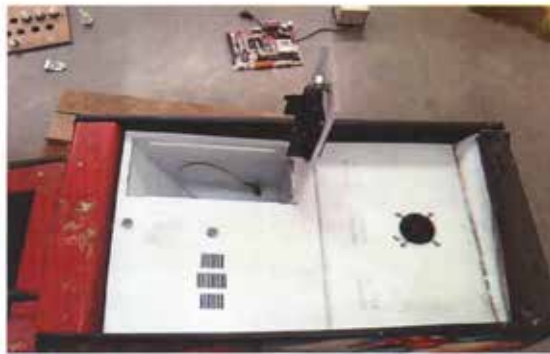
Figura 3 - Local preparado para instalação do coletor de cédulas (noteiro), o qual estava ausente
